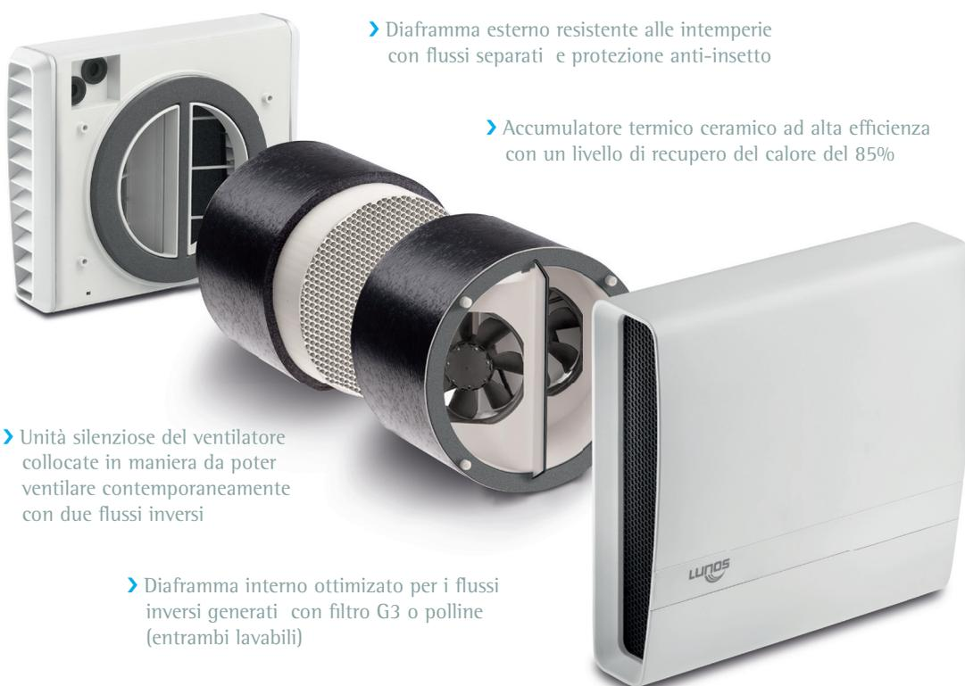
› Diaframma esterno resistente alle intemperie con flussi separati e protezione anti-insetto
